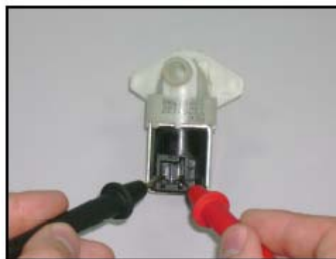
3750 \Omega \pm 10 (20°C) (BITRON ou TP)
