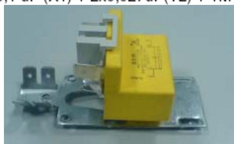
Condensateur Anti-parasite 0,1 µF (X1) + 2x0,027µF(Y2) + 1M Ω
