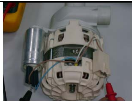
Mesure enroulement secondaire (câble bleu) 125 \Omega \pm 7 (NIDEC) 116 \Omega \pm 7 (WELLING)
