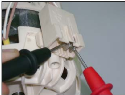
Mesure enroulement primaire 95 \Omega \pm 7 (NIDEC) 120 \Omega \pm 7 (WELLING)
